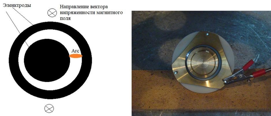
Рисунок 3.7 - Устройство искровых промежутков разрядников РВМГ
